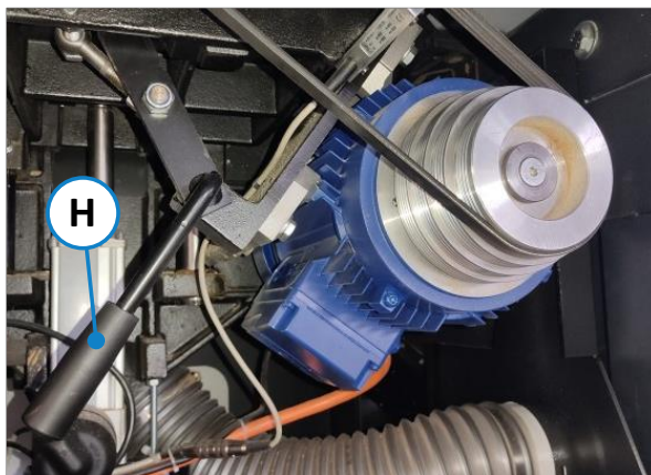
Figure 43 : réglage de la vitesse de rotation - desserrer la courroie trapézoïdale
