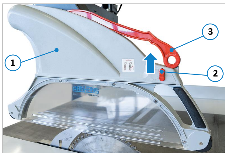
Figuur 25: Zaagkap vervangen
