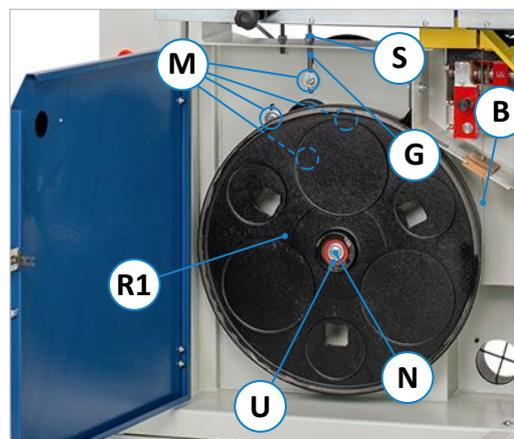
Figure 52 : remplacement de la courroie trapézoïdale
