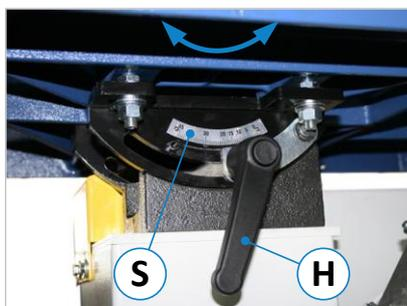
Figure 28 : réglage de l'inclinaison de la table
