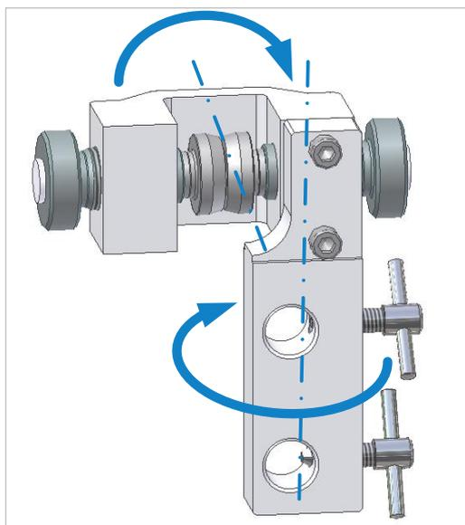
Figure 32 : conversion du guide inférieur à gauche
