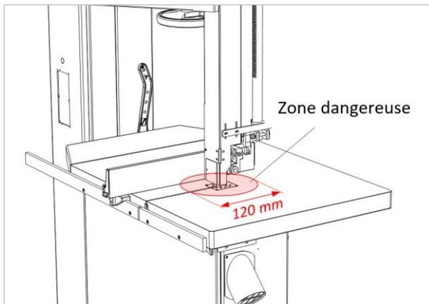
Figure 2 : zone dangereuse lame de scie
