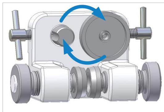
Figure 33 : conversion du guide supérieur à gauche
