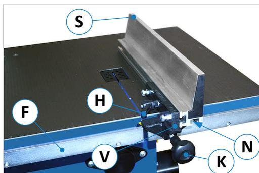
Figure 34 : réglage de la butée haut
