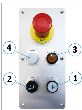
Figure 18 : commande par bouton poussoir 3,0 à 3,5 kW
