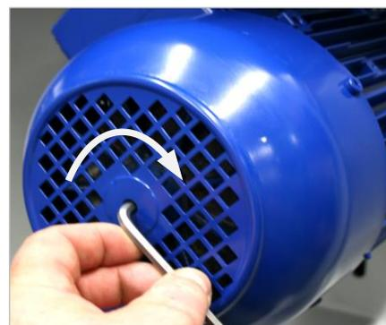
Figure 53 : réajuster le frein moteur
