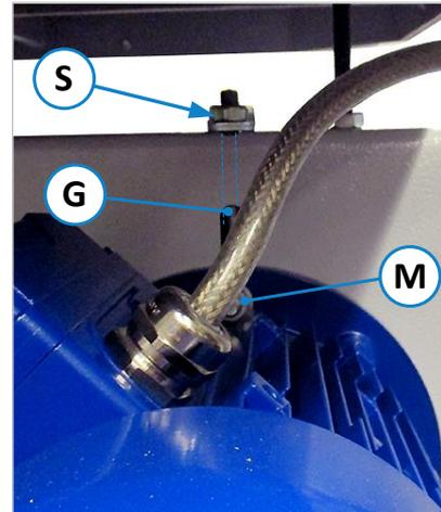
Figure 51 : resserrage de la courroie trapézoïdale
