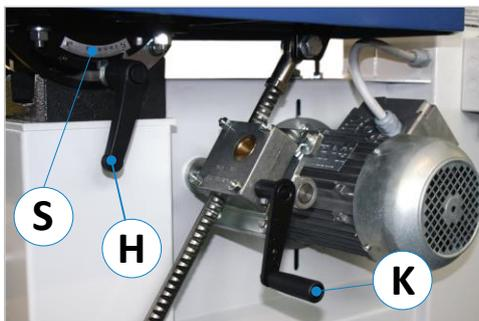
Figure 41 : réglage de l'inclinaison de la table
