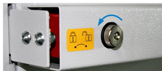
Figuur 24: Veiligheidsschakelaar - deur vergrendeld
