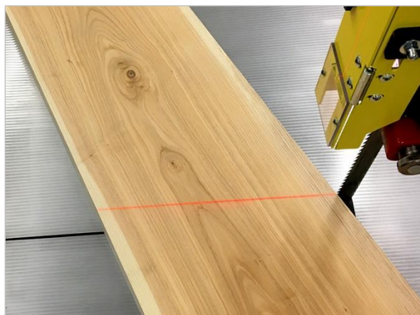
Figuur 47: Snijlijn weergegeven met laserstraal
