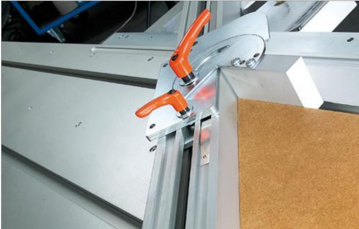
Figure 4 : guide d'onglet auxiliaire
