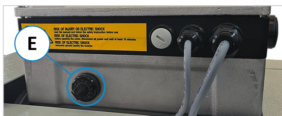
Abbildung 80: Einstellrad für stufenlose Geschwindigkeit
