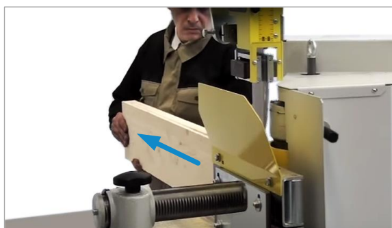
Abbildung 89: Werkstückteile abnahmeseitig entnehmen
