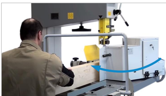
Abbildung 88: Vorschubeinheit zur Bearbeitung einrücken
