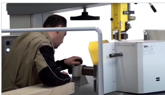
Abbildung 84: Schnittmaß am Rollenanschlag einstellen
