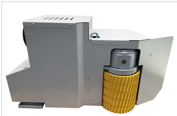
Abbildung 74: Standard-Vorschub (10-stufig verstellbar)
