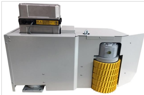
Abbildung 75: Optionaler Vorschub (stufenlos verstellbar)
