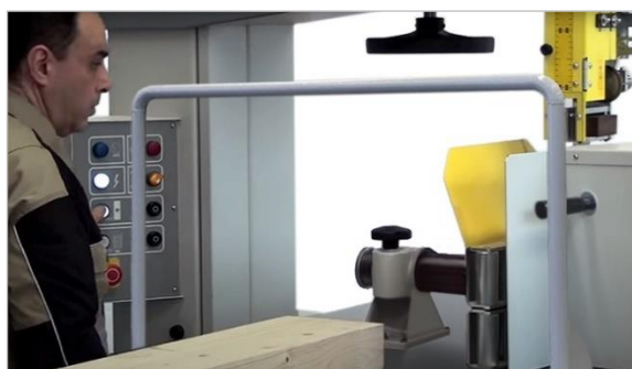
Abbildung 85: Bandsägeantrieb und Vorschub einschalten
