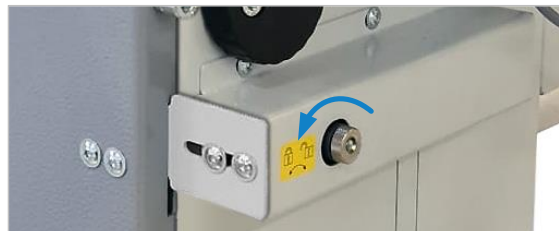
Abbildung 45: Sicherheitsschalter - Türe verriegelt
