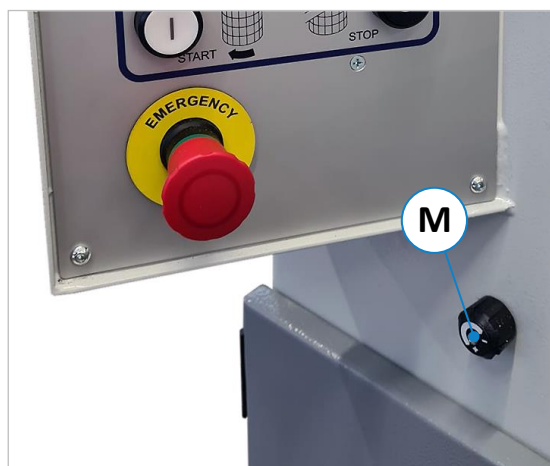
Abbildung 82: Einstellrad für die Schmierstoffmenge
