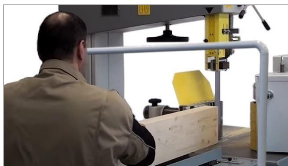
Abbildung 87: Werkstück auflegen und zum Anschlag führen
