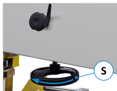
Figure 57 : tension de la lame de scie
