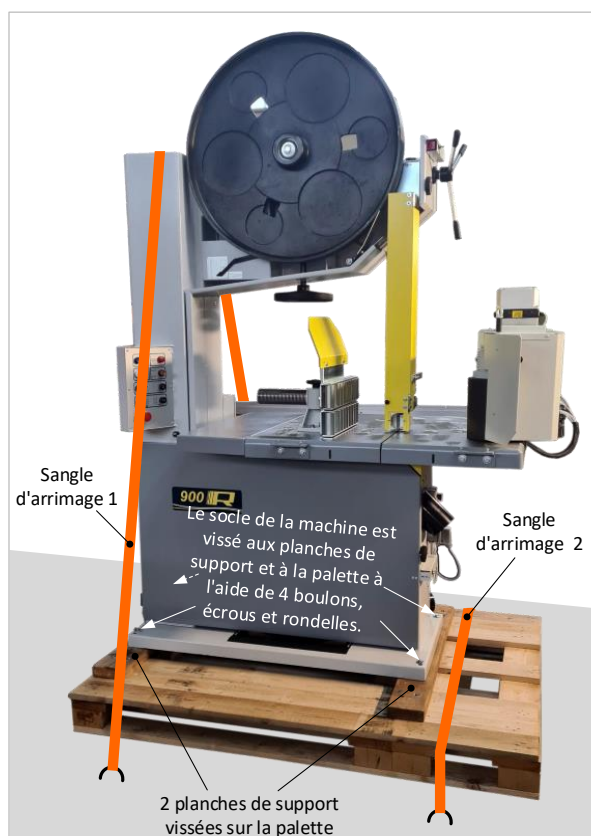
Figure 12 : arrimer la machine sur une palette
