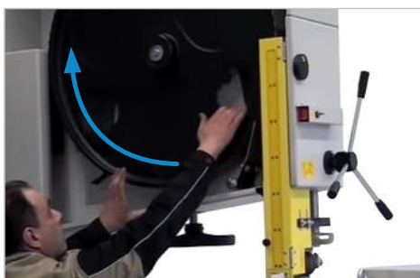
Figure 59 : aligner la lame de scie à ruban
