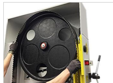
Figure 55 : insérer la lame de scie
