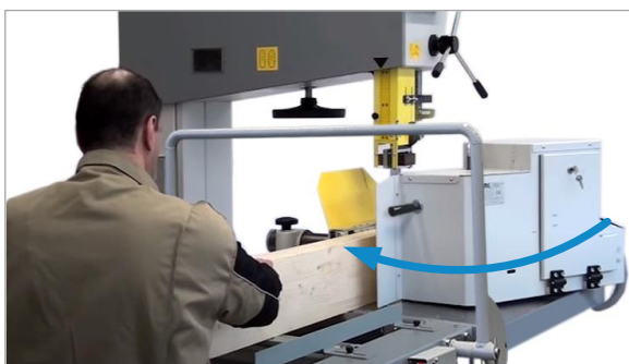
Figure 88 : pivoter l'unité d'avance pour l'usinage
