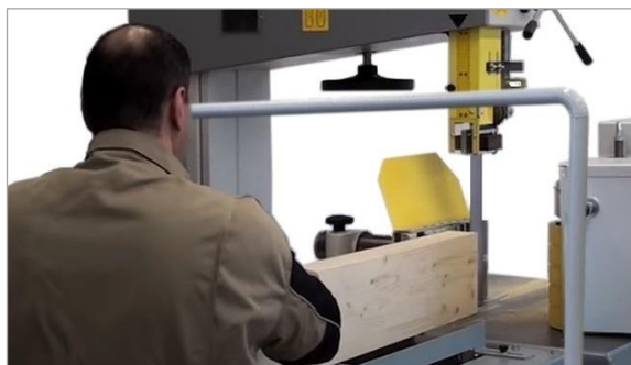
Figure 87 : poser la pièce et la guider jusqu'à la butée
