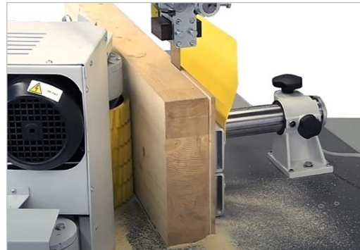
Figure 2 : opération d'usinage à la scie à ruban
