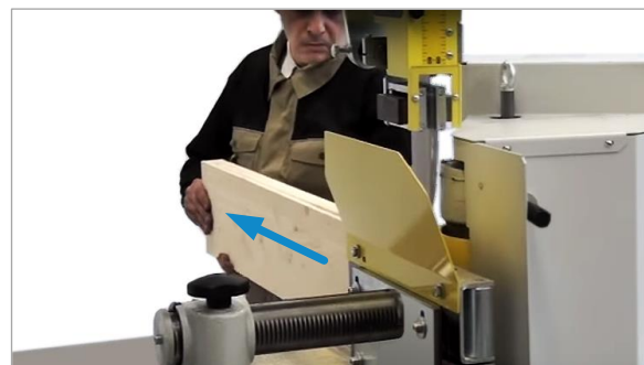
Figuur 89: Werkstukdelen aan de uitvoerszijde verwijderen
