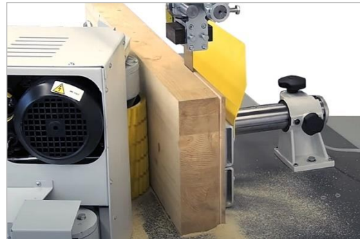
Figuur 2: Bewerking op de bandherzaag
