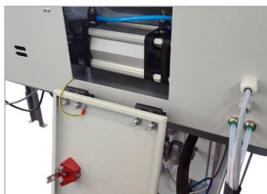
Figuur 34: Noodstop aanvoerklep
