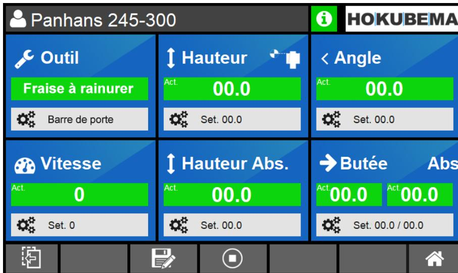
Figure 7 : aperçu de la machine avec outil, axes et vitesse de rotation (exemple 245|300)
