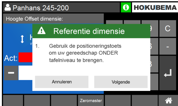
Figuur 12: De gereedschapshoogte kalibreren met de Zeromaster
