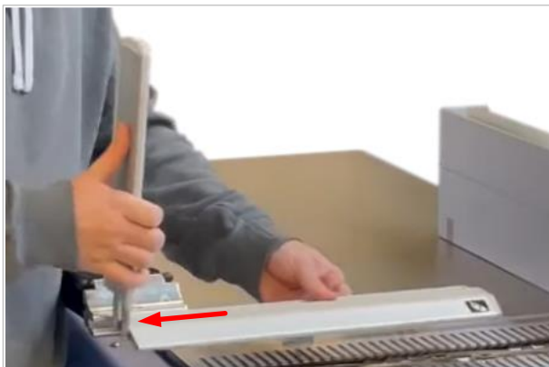
Figure 6: Brückenschutz auf Führung aufschieben
