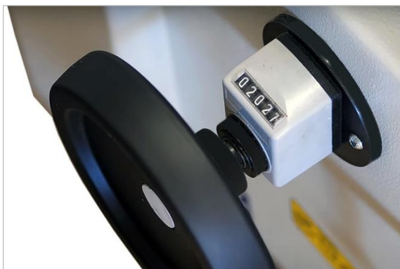
Abbildung 40: Zählwerk zur Feineinstellung der Höhe
