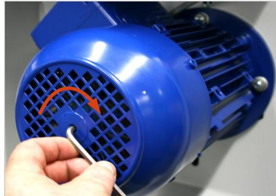
Abbildung 45: BSM 7-60 Motorbremse nachjustieren
