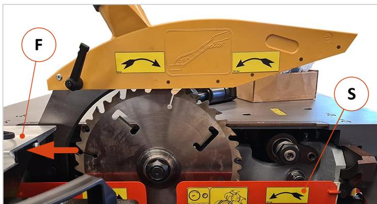
Abbildung 19: Zugang zur Späneklappe herstellen
