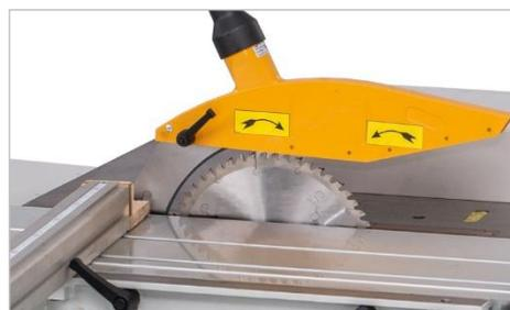
Abbildung 1: Kreissägeblatt mit Schutzhaube
