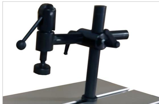
Abbildung 48: Exzentrerspannvorrichtung
