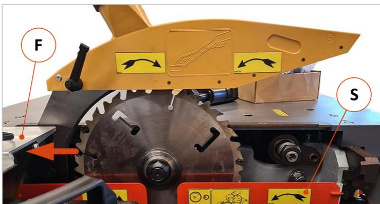
Abbildung 19: Zugang zur Späneklappe herstellen
