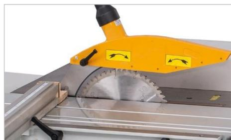
Abbildung 1: Kreissägeblatt mit Schutzhaube
