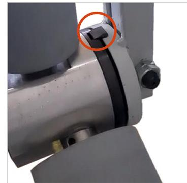
Abbildung 33: Revolver eingerastet
