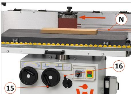
Abbildung 43: Furnierüberstand planschleifen
