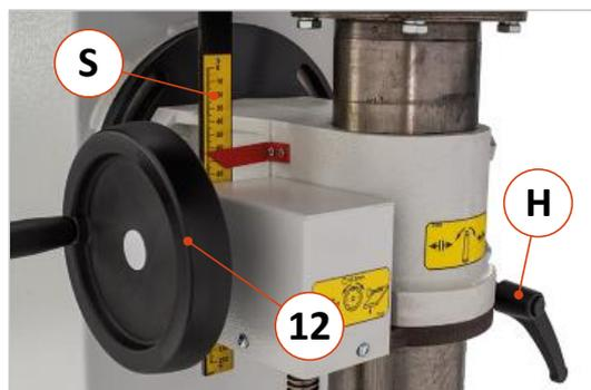
Abbildung 17: Höhenverstellung mit Handrad und Skala
