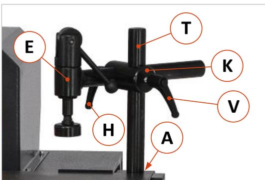
Abbildung 10: Exzenterstapanner montieren
