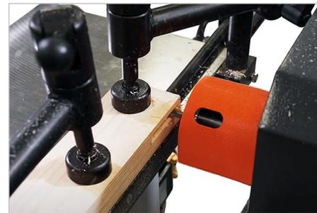
Abbildung 1: Bearbeitung „Langlochbohren“
