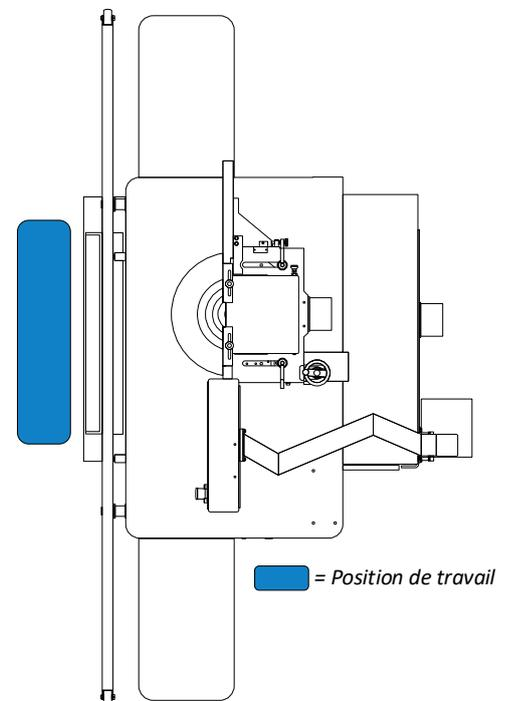
**L'espace nécessaire :** L'espace effectif nécessaire dépend en général des dimensions de la machine et des dimensions des pièces à usiner. Prévoyez en général suffisamment de place autour de la machine et calculez également l'espace de travail nécessaire pour le personnel de service, d'entretien et auxiliaire ainsi que pour l'amenée et l'évacuation des pièces à usiner.
