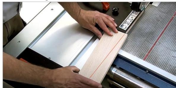
**Hinweis:** Der Sterngriff zur Klemmung und das Führungselement der schiebenden Platte (Richtung Bedienerseite) können bei Bedarf durch Herausrauben entfernt werden (siehe Foto unten links).
