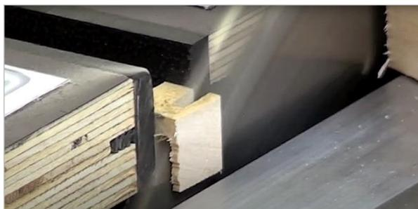
Fixieren & beschädigungsfreies Schneiden kleinster Werkstücke:
