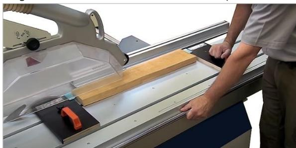
Querschnitte an schmalen Werkstücken:
