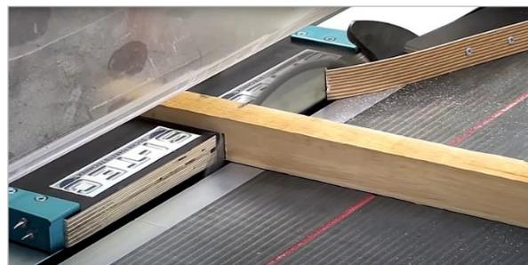
Fixieren & Schneiden von sehr kurzen und kleinen Werkstücken:
