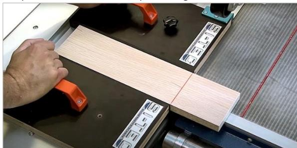
Fixation sûre via des pointes de serrage pour les coupes en biais :
