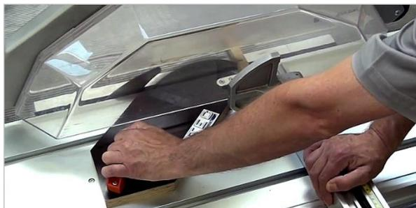
Abgelängtes Werkstück entnehmen:
