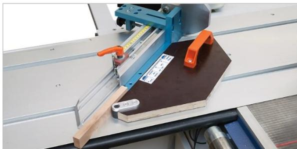
Wir empfehlen zudem die Anwendung in Kombination mit der Anschlagverlängerung „Safety-Cut plus“ (Art.-Nr. 3367), die als Erweiterung des „Safety-Cut“ (Art.-Nr. 3366) verfügbar ist und den Längenanschlag um zusätzliche 300 mm verlängert.
