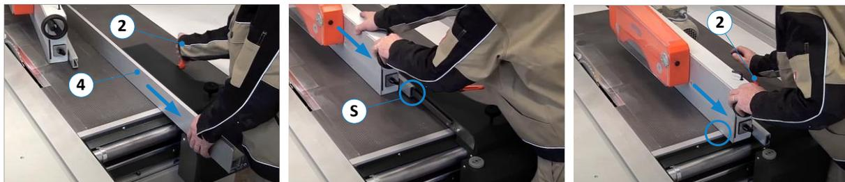
Abbildung 2: Vorschubapparat montieren
